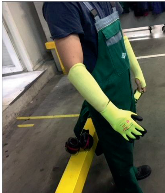
2 számú kép: Alkarvédő és vágásbiztos védőkesztyű helyes viselésének gyakorlati bemutatása oktatás során.
